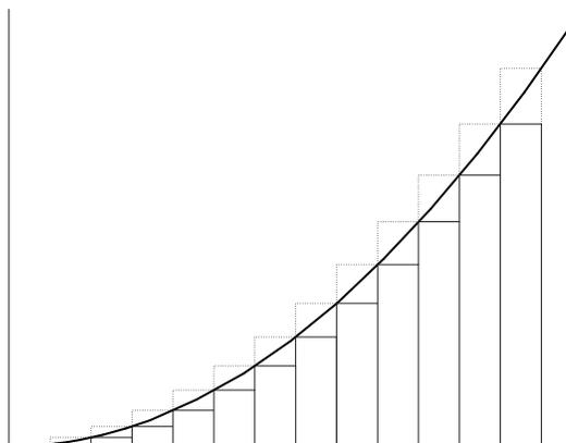
**FIGURA 0.12** El área bajo la parábola se *atrapa* entre rectángulos por arriba de la curva y rectángulos por abajo. Se obtienen sumas aproximadoras por exceso y por *defecto*.
