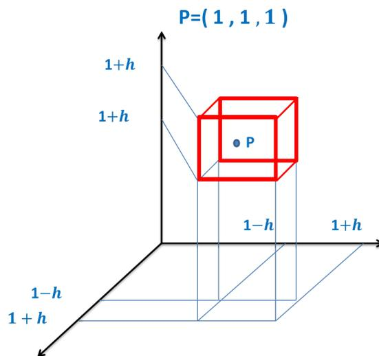
**Solución** En este caso La definición de gradiente, aplicada a un volumen como el de la figura, genera seis integrales de superficie, una por cada cara del paralelepípedo. Vamos a trabajar las caras cuyo vector normal es paralelo al eje X
