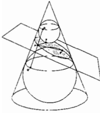
Las esferas inscritas en el cono son tangentes al plano de corte, por encima y por abajo, en los puntos F y F'. Al ser  $PF = PQ$  y  $PF' = PQ'$ , ya que son iguales dos tangentes de un punto exterior P a cualquiera de las esferas, resulta que
