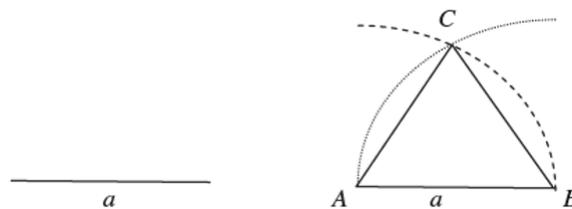
Los lados AB y CA tienen la misma longitud porque ambos son radios del primer círculo. Los lados AB y BC tienen la misma longitud porque ambos son radios del segundo círculo. Por lo tanto, los tres lados del triángulo ABC son iguales.
