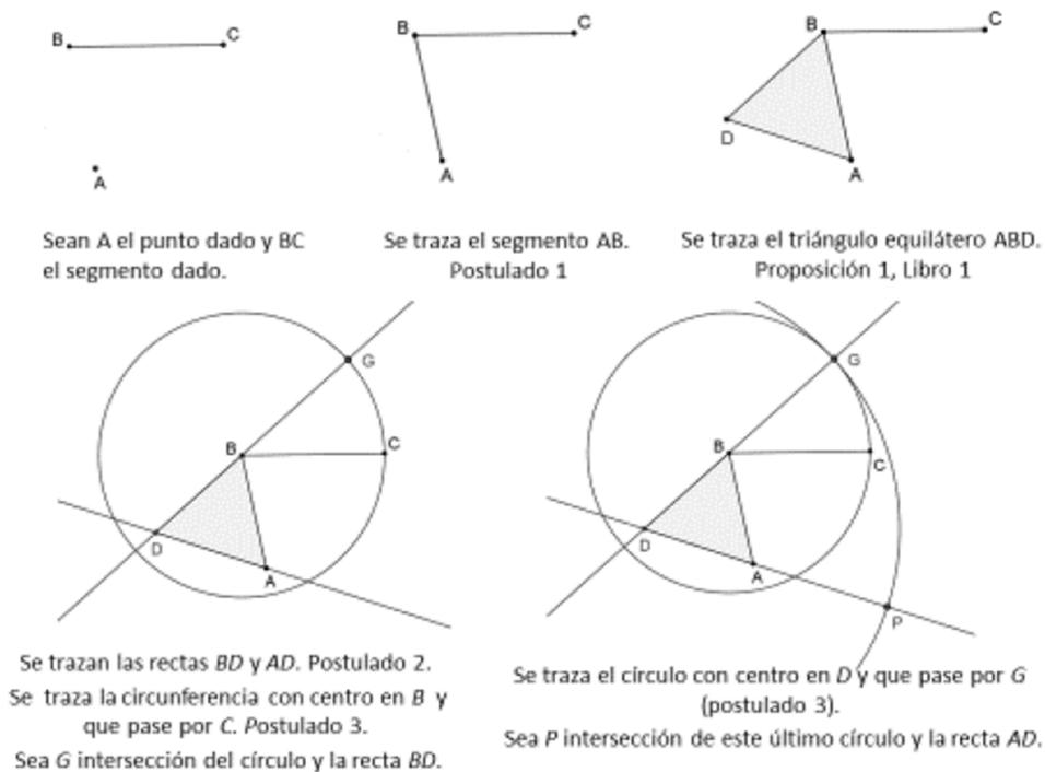
Esta construcción permite afirmar que cualquier construcción que se puede realizar con el compás moderno se puede también realizar con el compás euclidiano, aunque por un procedimiento más largo, porque cada vez que se requiere trasladar segmentos hay que hacer esta construcción adicional. Sin embargo, ya que los dos compases son equivalentes, usaremos el moderno por razones prácticas, sin pérdida de rigor.
